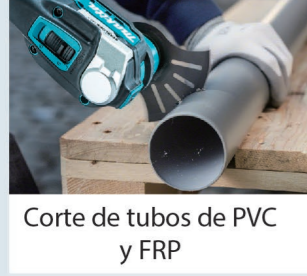
Corte de tubos de PVC y FRP
